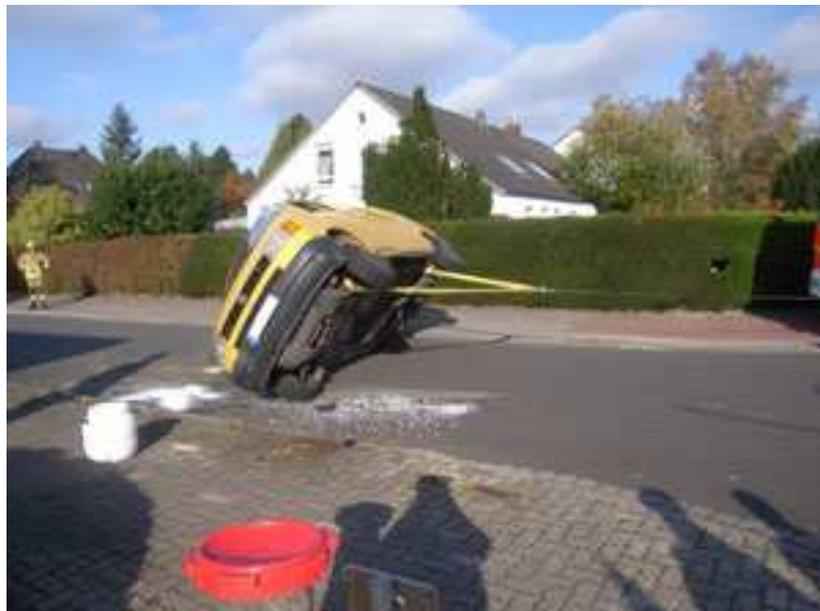
Mit der Seilwinde des Rüstwagens wird das Fahrzeug aufgerichtet
