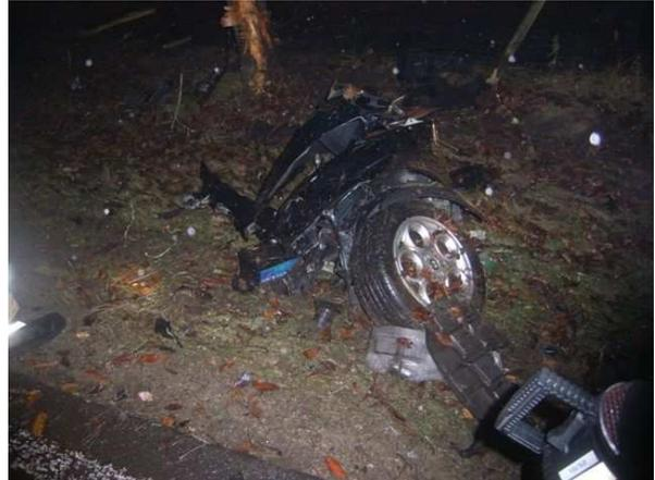
Ein Teil der Vorderachse wurde bei dem Aufprall auf den Baum herausgerissen
