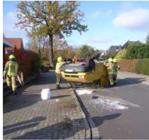
Anschlagen des Stahlseils zum Umdrehen des Fahrzeuges
