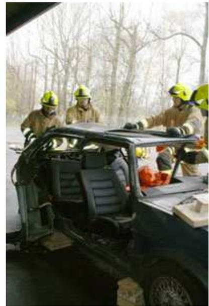
Hier wurde mit Schere und Blechaufreißer gearbeitet.
