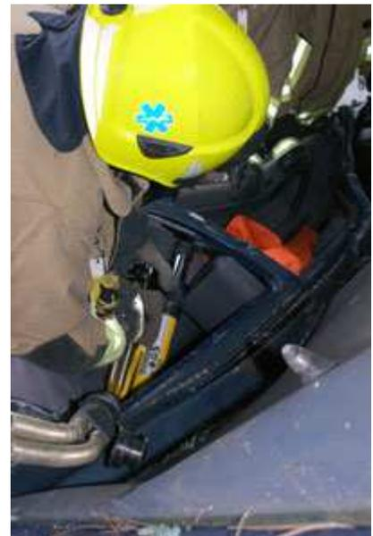
Roaming - Zurückverformen der Karosserie mit Hydraulikzylinder
