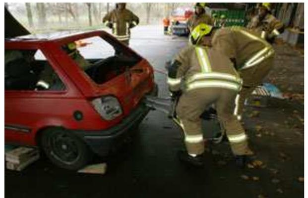
Öffnen der Heckklappe mit Spreizer
