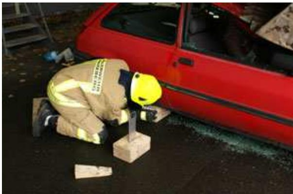
Stabilisieren des Fahrzeuges mit Holzkeilsystem
