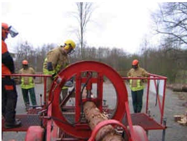
Mit einer Hydraulik wird der Baumstamm unter Spannung gesetzt
