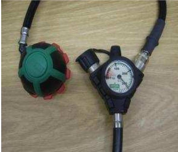
Der Überdruck-Lungenautomat AutoMaXX AE erleichtert mit seiner großen Membran die Veratmung, daneben das Verteilerstück mit Hochdruckmanometer, Warnpfeife und Zweitanschluss.
