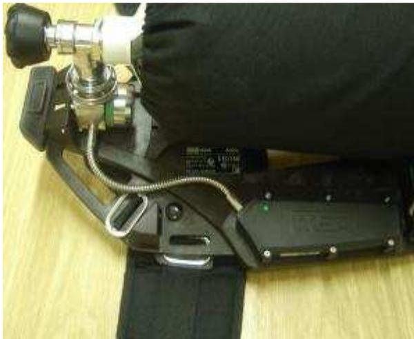
Der Kurzstreckenfunksender alphaMITTER sendet sekundlich Druckdaten zur persönlichen Überwachungseinheit alphaSCOUT.
