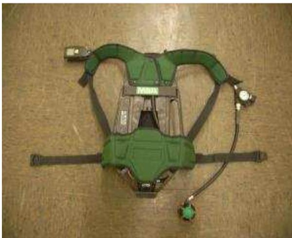
Durch das erheblich verringere Gewicht ist der Tragekomfort gesteigert und somit eine Entlastung der Atemschutzgeräteträger erreicht worden. Die alten Geräte mit zwei 4 ltr.-Stahlflaschen wogen ca. 18 kg, die neuen Geräte mit einer 6,8 ltr.-Composite-Flasche wiegen nur noch 11 kg. Die vorhandene Luftmenge ist dabei noch leicht vergrößert worden.
