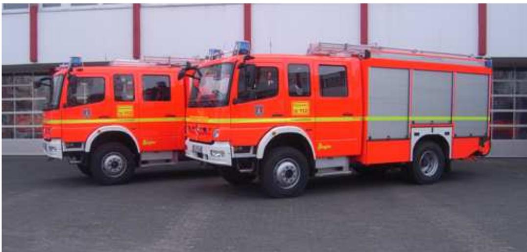
Neben einem Löschwasserbehälter mit 2000l Inhalt und einem ebenfalls geteilten Schaummittelbehälter werden diverse Feuerlöscher u. a für Metallbrände und Brandklasse F mitgeführt.
