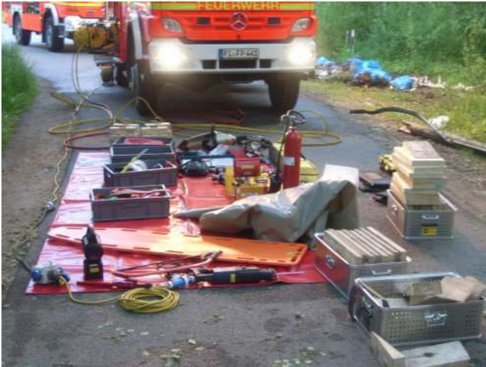
Ablageplatz für die Rettungsgeräte
