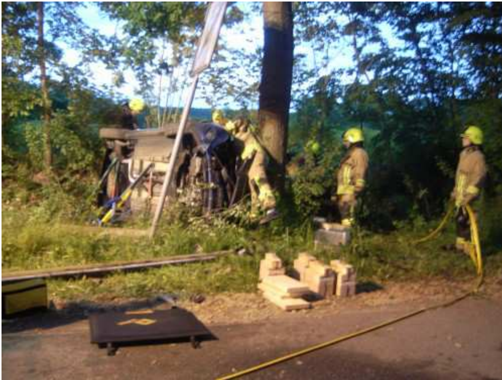
Der PKW wird mit „stab-fast“ Holzplatten und – keile stabilisiert
