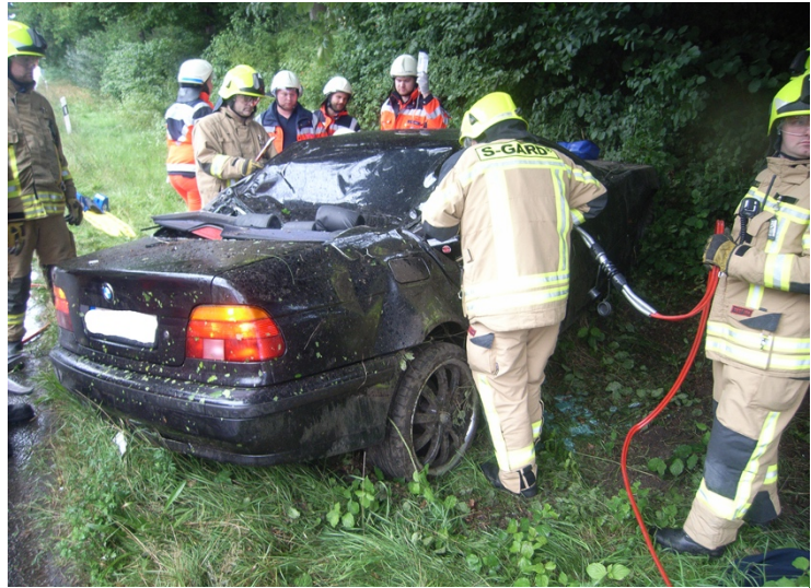
Um das Dach abzunehmen musste zeitweise auf den Rettungssatz vom RW zurückgegriffen werden. Die Fahrgastzellen stellen häufig eine Herausforderung dar.
