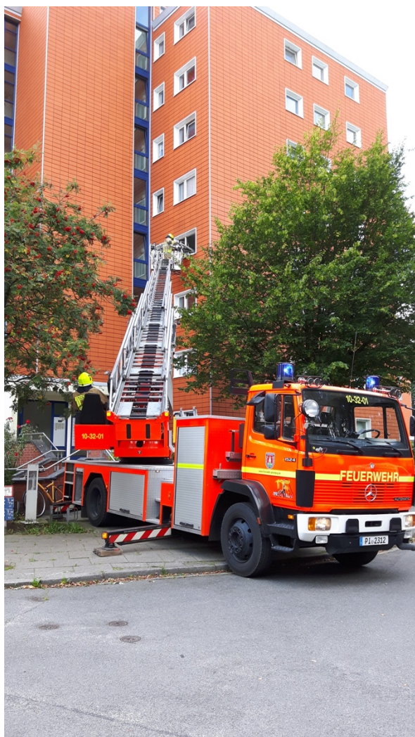
Die Richtige Positionierung der Drehleiter kann die entscheidenden Zentimeter Ausladung im Einsatz bringen. Das muss immer wieder an Objekten geübt werden. Im Ernstfall können Zentimeter Leben retten.
