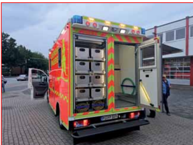
Heckansicht unseres Gerätewagen Hygiene. Gut erkennbar sind die Boxen für die verschmutzten Atemschutzgeräte.
